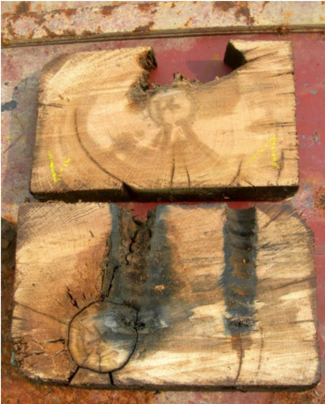
Fig. 16: Querschnitte aus der ausgebauten Schwelle zeigen deutlich den fortgeschrittenen Fäulnisprozeß (dunklere Braunfärbung) in Verbindung mit Rissen..
